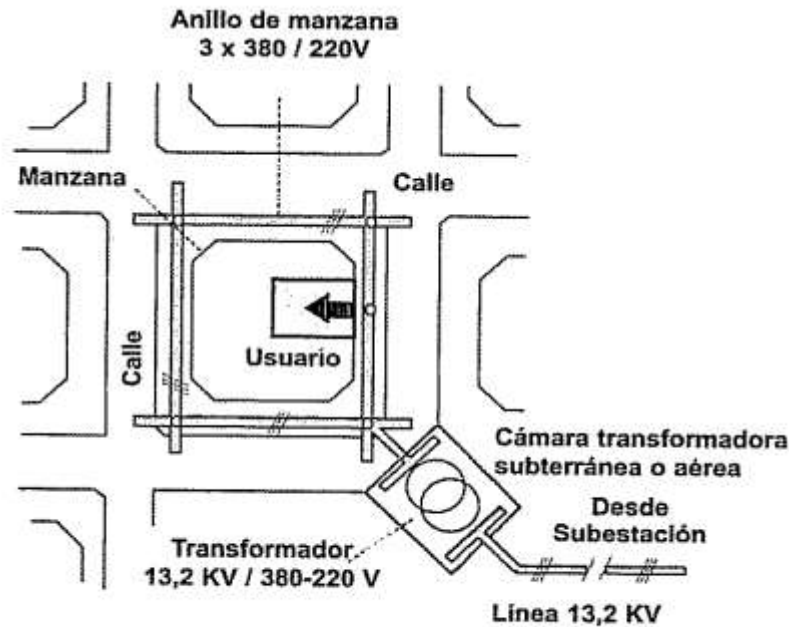
Figura 24-I. Esquema básico de distribución urbana
