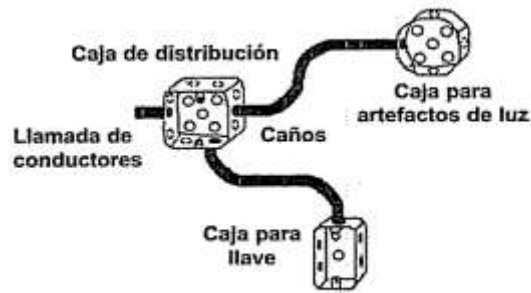
Figura 7-II. Detalle de montaje de caja de distribución
