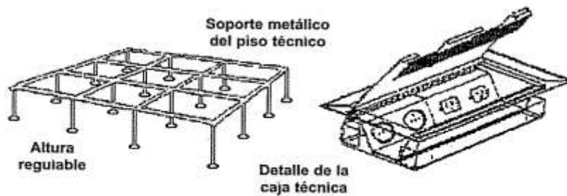
Figura 22-II. Detalles de montaje de piso técnico
