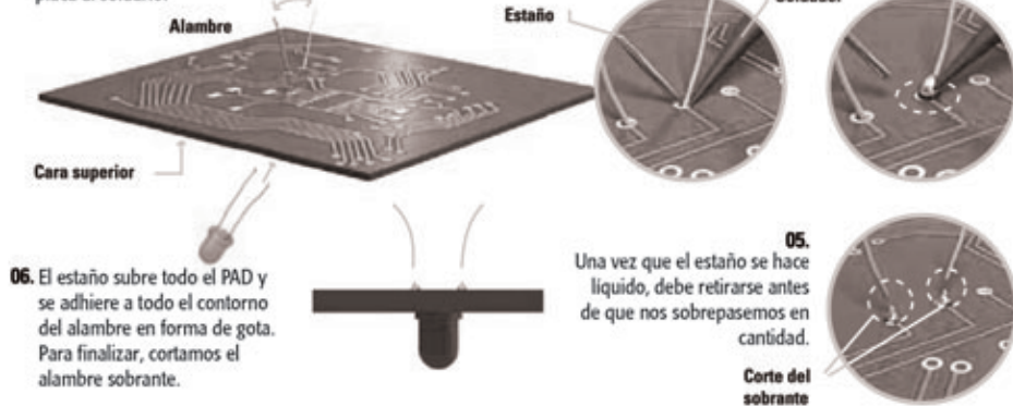
FIGURA 14. En estos pasos, analizamos cómo realizar el soldado de componentes through hole.
