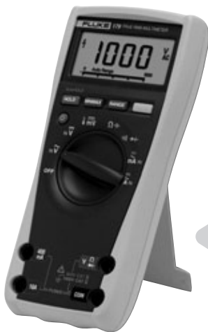
FIGURA 4. Observamos la rueda de selección de un multímetro digital con los alcances y tipos de medición que se pueden realizar.
