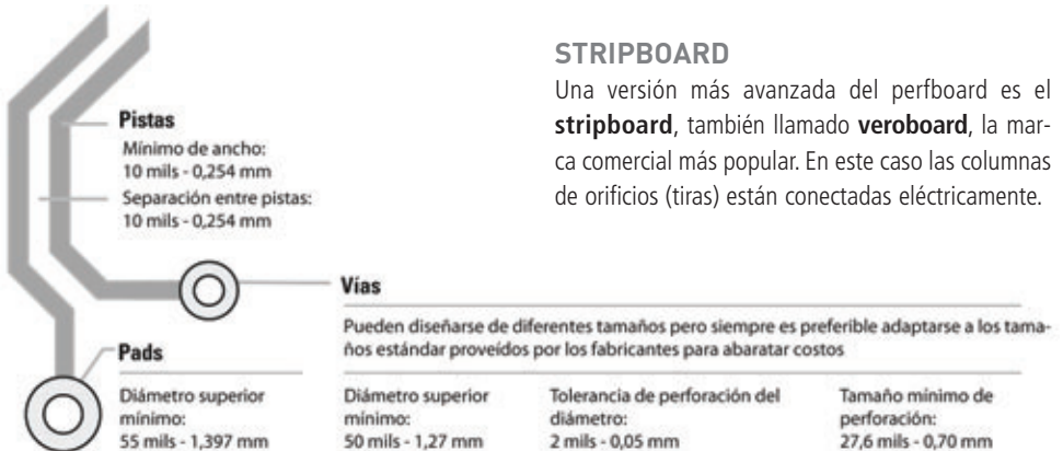
FIGURA 8. Vemos el ejemplo de especificaciones de un fabricante. Existe la posibilidad de trabajar con pistas más finas y vías más pequeñas.
